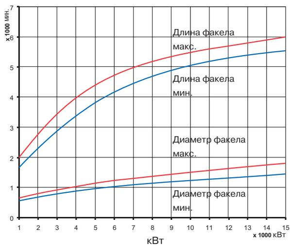
Размеры даны для дизельного топлива и газа. Для мазута надо использовать большие размеры.
