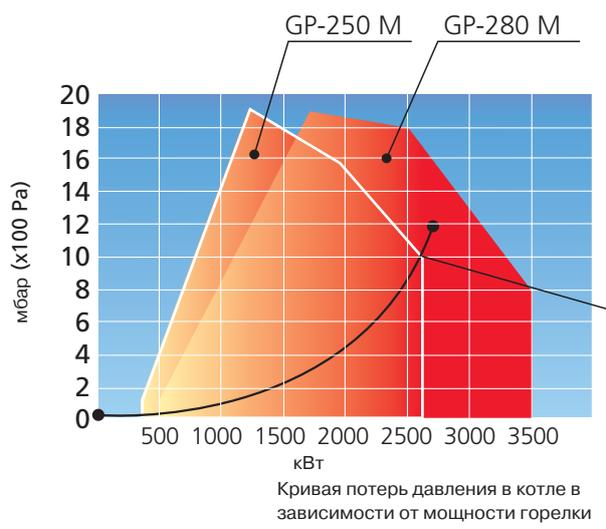
Максимальная мощность водогрейного котла - 2500 кВт, соответствующая мощность горелки - 2500 кВт / 0.9 = 2780 кВт. По графику видно, что для этой мощности подходит газовая горелка GP-280 M, так как кривая потери давления располагается внутри кривой мощность/противодействие горелки GP-280 M. Если котел не будет эксплуатироваться на полной мощности, то можно выбрать горелку GP-250 M. Не забывайте учитывать КПД при сравнении кривой потерь давления котла и кривой мощность/противодействие горелки.
