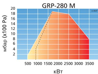
Природный газ: теплотворная способность  $H_u=9,5$  кВт.ч/н.м<sup>3</sup> (34,3 МДж/н.м<sup>3</sup>)
